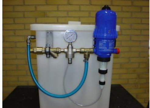
Der SALT-02 MK2 injiziert eine konzentrierte Salzlösung in den Wassertank der Eismaschine.
