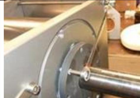
Lager entfernen und reinigen.
