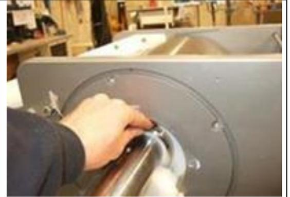
Führungsbänder austauschen. Sie lassen sich mühelos mit einem kleinen Schraubenzieher entfernen. Die neuen Führungsbänder montieren.
