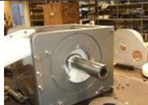
Klemmenring demontieren und an allen Flächen reinigen.
