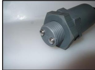
Wenn die Eismaschine mit einem Salzdosierer geliefert wird, sind Fühler und Pumpe im Eismaschinengehäuse montiert. Bei Nachlieferung eines Salzdosierers hat der Anschluss des Fühlers vor Ort zu erfolgen.
