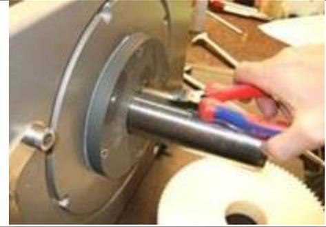
Mit den Schrauben in den Gewindelöchern das Gewindegehäuse vorsichtig von der Stirnseite abziehen.
