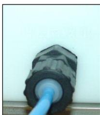
Wasserdruck Einlass: Min 1 Bar. Max. 3 Bar.
