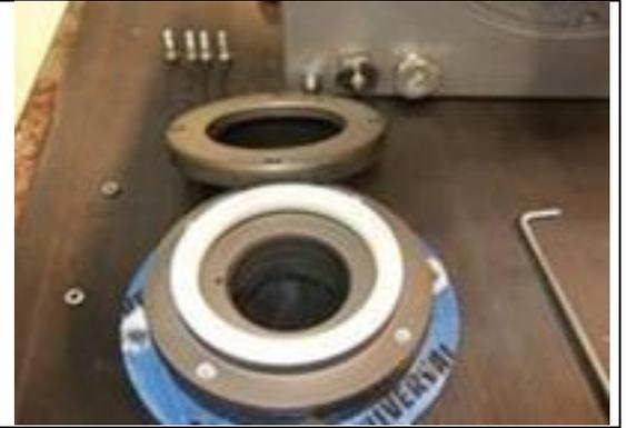
Wasserdichtungsring austauschen. Die Fläche, an der der Wasserdichtungsring anliegt, reinigen und polieren.
